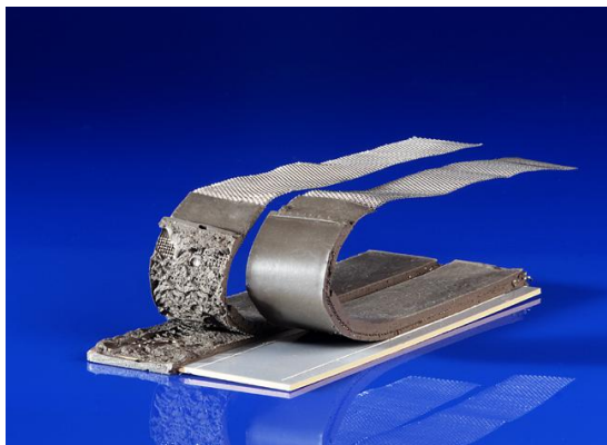
Proefstukken na destructief testen met behulp van Peeltest, resp. Afschuiftest Bron: Fraunhofer IFAM
